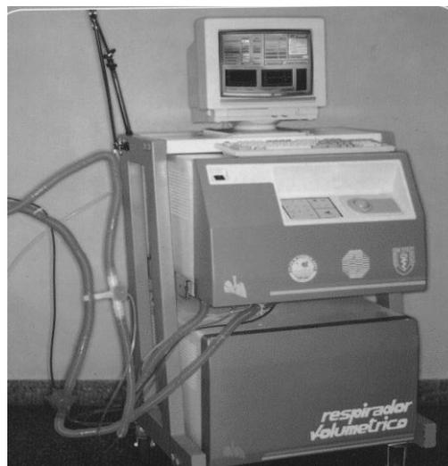
Fotografía del primer prototipo de ventilador pulmonar
